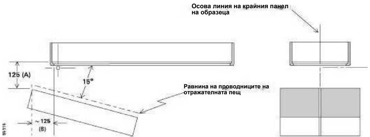
Фигура 3 - Образец - Подрездане на панела
