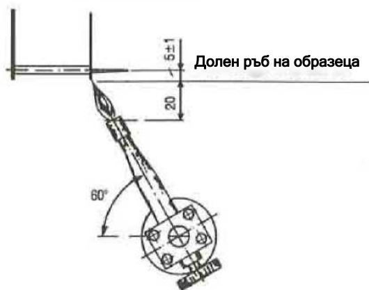
Фигура 2 - Горелка за запалване: позиции на плата
